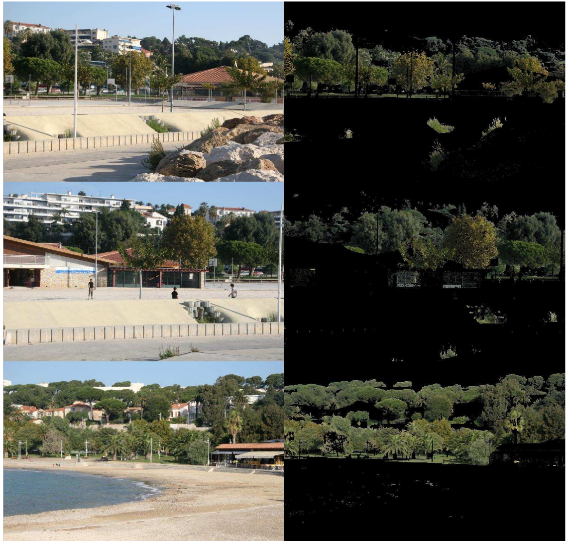
Figure 5-0 Test de séparation simple naturel/artificiel en s'appuyant uniquement sur la couleur (distribution des valeurs rouge,vert,bleu en normalisé).
