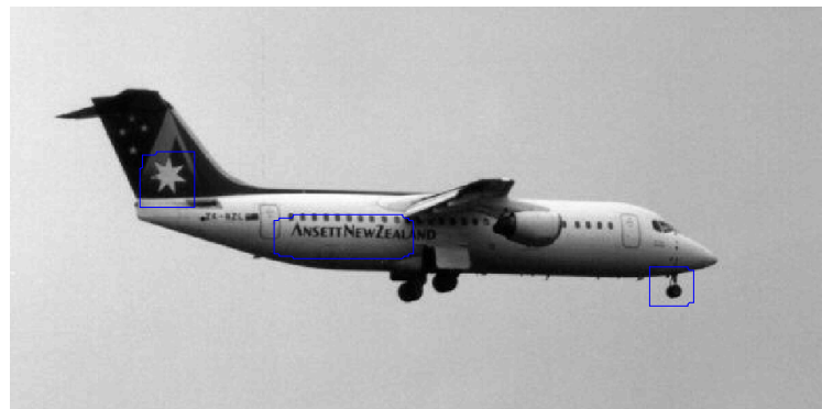
Figure 5-0 Extraction des blocs les plus marginaux sur une image de la base « airplanes ». Ces blocs image sont uniques relativement aux invariants utilisés par la compression fractale et à la liste de seuils d'erreurs de reconstruction. Ici ils représentent le nom de la compagnie, le logo et le train avant de l'appareil.
