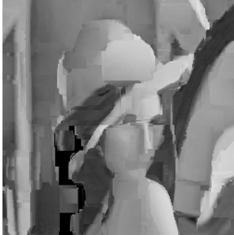
Figure 4-0 Reconstruction type obtenue à partir de ranges extraits par inter corrélation normalisée. Le PSNR est de 21 avec des ranges 16x16 et des échelles range/domaine [1 1,5 2]. Nous remarquons que la géométrie est conservée mais que les parties fortement texturées sont aplanies, seule la géométrie globale de l'image est conservée. Cela est dû à la nature de l'opérateur choisi et à la taille de blocs image considérés.
