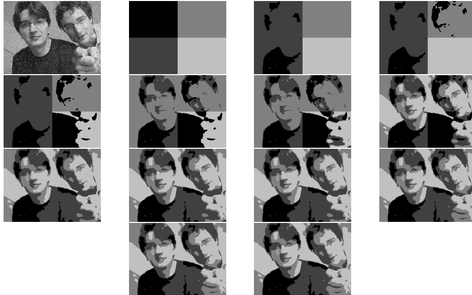
FIG. 2.13 – Deux premières passes d' (\alpha, \beta) -swap pour le débruitage 4 niveaux de gris. En haut à gauche : image originale, puis l'initialisation et les (\alpha, \beta) successifs.
